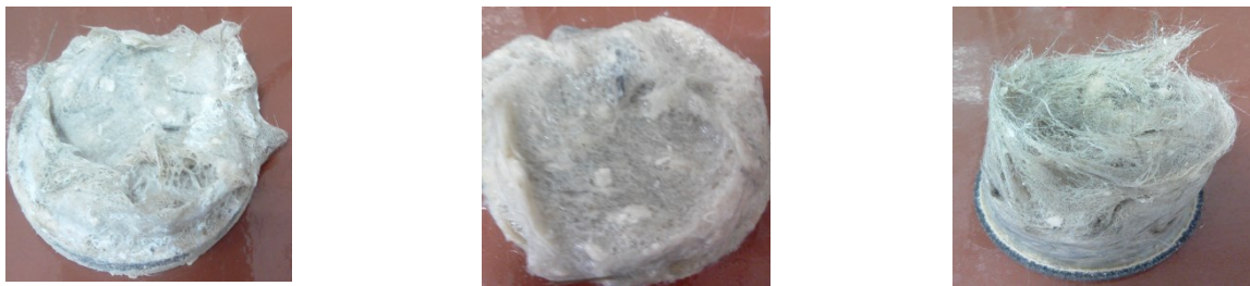
Рисунок 2. Образовавшийся субстрат с керамическими фильтрами проницаемостью 54 мД при температуре 74°С (слева-направо: перепад давления 2,07; 2,76; 3,45 МПа)
